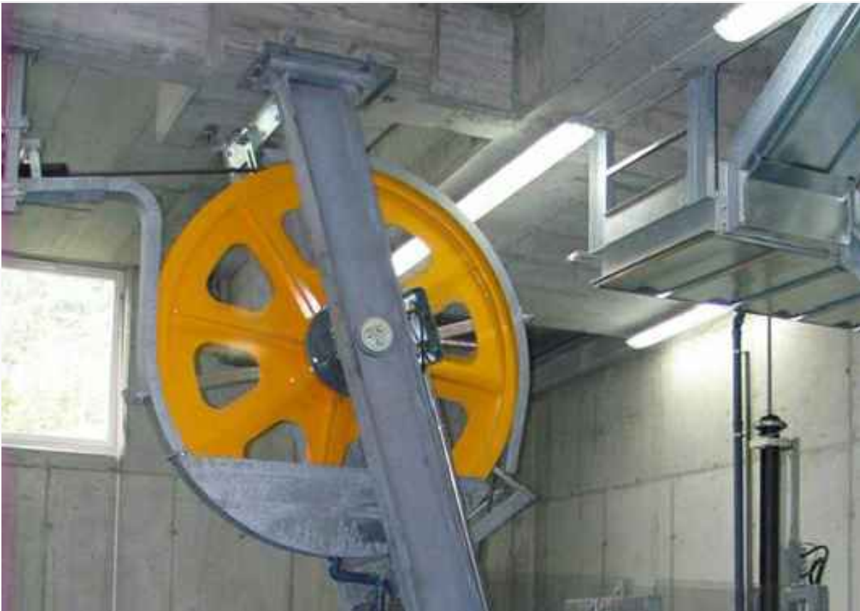
Nuova tipologia di puleggia di deviazione
